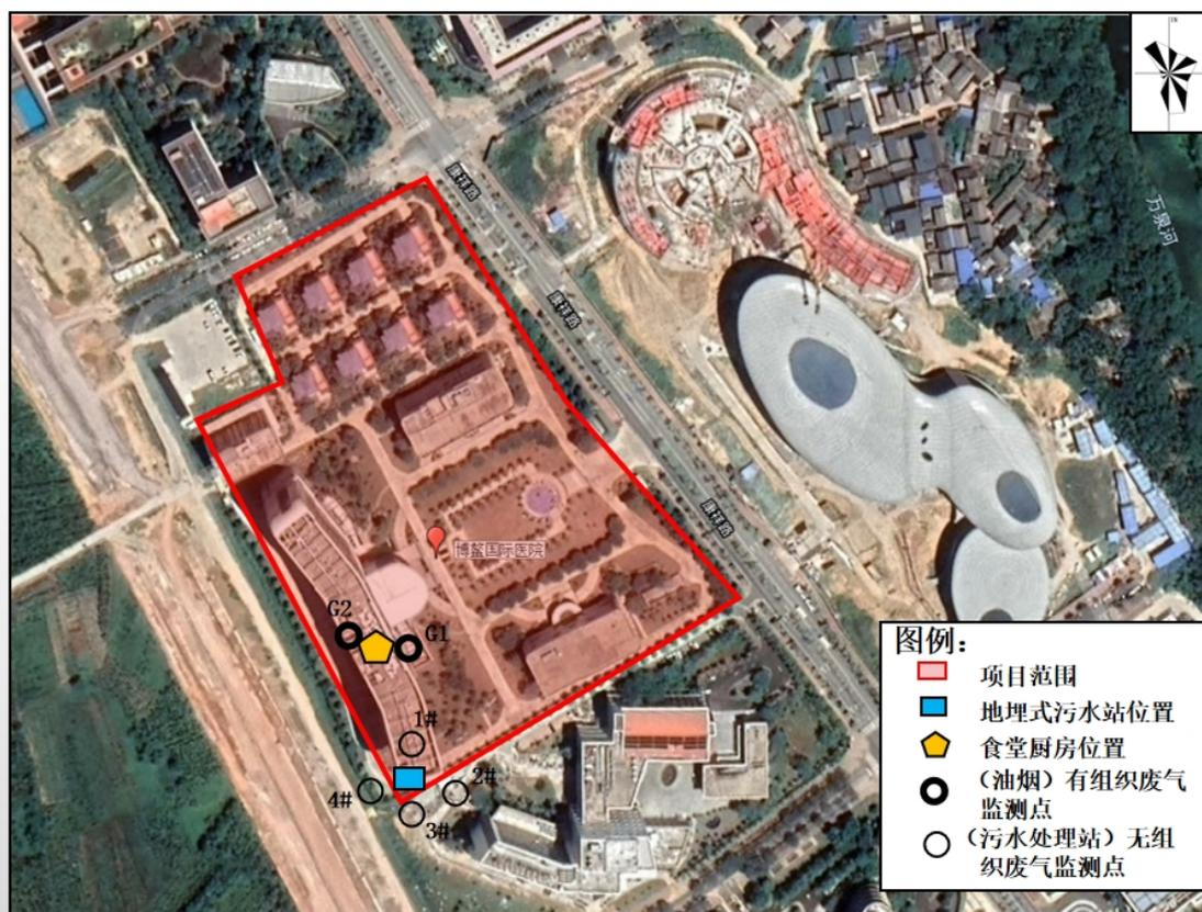
图 8-2 油烟废气、污水处理站无组织废气监测点位
